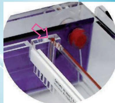
Minigelsystem: gedrehter Gelträger mit 'End Gates' (roter Pfeil)
